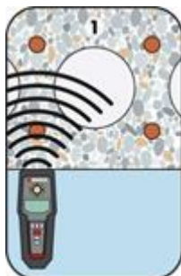
Repérer l'emplacement de la première armature précontrainte
