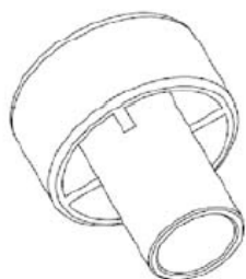
Embout de remplissage pour mise en œuvre horizontale ou au plafond Diamètre de perçage (d 0 ) : 24 mm à 40 mm
