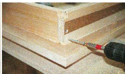
Fabrication d'encadrements de portes et chassis de fenêtres.
